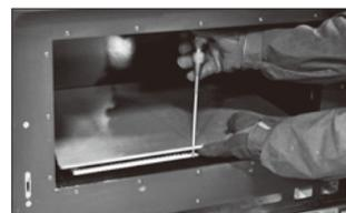
↑ 付属のオペレーションツールやドライバーを穴に入れてオープンアクセスプレートを持ち上げて外し掃除します。
