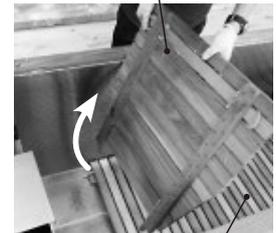
次に、写真のように「底面用すのこ」の端を持ち上げ、ストープ設置方向に引いて取り外します。
