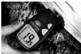
←含水率計 針を薪に差し込むと薪の乾燥度がひと目でわかります。
