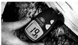
↑含水率計 針を薪に差し込むと薪の乾燥度がひと目でわかります。
