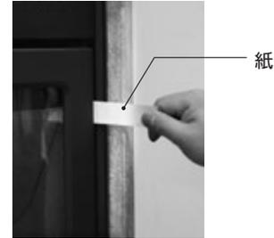
紙を長方形にカットし、ドアと本体の間に挟みこんで燃烧室ドアをロックします。
