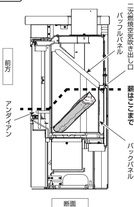
薪を燃焼室上部のバックパネルに当たるまで入れないでください。薪の投入量は燃焼室奥にあるバックパネル上部の二次燃焼空気吹き出し口より下まで、なおかつ燃焼室入り口にあるアンダイヤンを超えて落ち出ない高さにしてください。薪がくすれてガラスに当たらないように注意してください。
