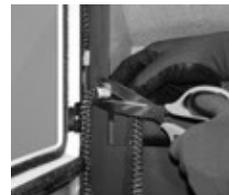
**1** ドアを開けて、劣化したファイバーロープを引き剥がします。
