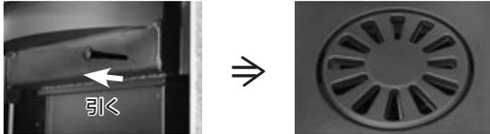
**補足** 燃焼室の灰は、一定量（2cm以下）必要です。しかし、グレートの開口部から出る空気を妨げないようにグレートレバーを前後に動かし、灰を落としてください。
