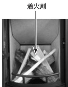
**補足** 燃焼室の各パネルは薪に着火してから燃焼室が高温になるまで、黒いススが付いた状態になります。やがて温度が上がって十分な温度が得られるとススが取れ、もとの状態に戻ります。
