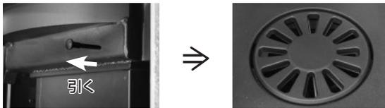
**補足** 燃焼室の灰は、一定量（2cm以下）必要です。しかし、グレートの開口部から出る空気を妨げないようにグレートレバーを前後に動かし、灰を落としてください。
