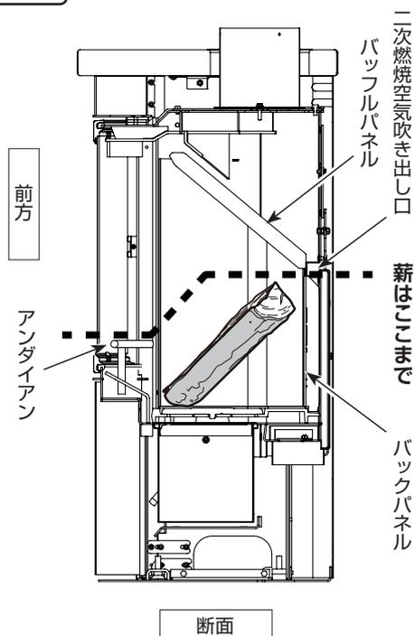
薪を燃焼室上部のバツフルパネルに当たるまで入れないでください。薪の投入量は燃焼室奥にあるバックパネル上部の二次燃焼空気吹き出し口より下まで、なおかつ燃焼室入り口にあるアンダイヤンを超えて落ち出ない高さにしてください。薪がくすれてガラスに当たらないように注意してください。
