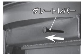
いずれの場合も灰は炉床に2cm程度残り、グレートレバーを押し、グレーを閉めた状態にします。灰受けボックスの中に灰が8割程度溜まったら安全に処分してください。
