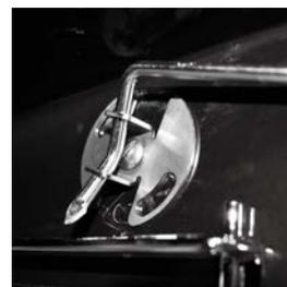
→ 付属の操作ツール、または熱に強い革製のグローブを利用してバルブを回転させます。
