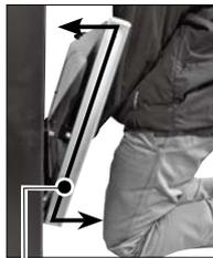
←持ち上げたら両手でドア底部を保持し、少しだけドアを手前に引きます。引いた状態で支点を中心にドアを引くと外れます。
