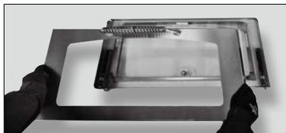
**2** フロントカバーを外したら、ペアガラスが欠けないよう注意して取り外します。濡れたスポンジやふきんで拭き取り、汚れがひどい時はガラスクリーナーで拭き取ってください。ガラスクリーナーをご使用後、乾拭きしてください。
