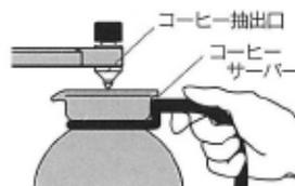
**ポイント** コーヒーバルブを閉め、加熱を続けると圧力が高まるので勢いよくコーヒーが抽出されるようになり、最終的には「シュー」という音と共に蒸気とコーヒーが出てきます。この状態で抽出されるコーヒーは熱く苦みが強くなります。この状態にするとクレマ（細かい泡）が多く発生します。
