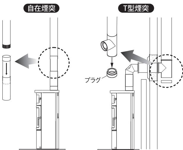
自在煙突の場合は、ストーブ口元と煙突を固定しているネジと自在型煙突の上部固定ネジ(またはバンド)を取り外し、自在型煙突を下方にスライドさせ煙突を本体から取り外します。
