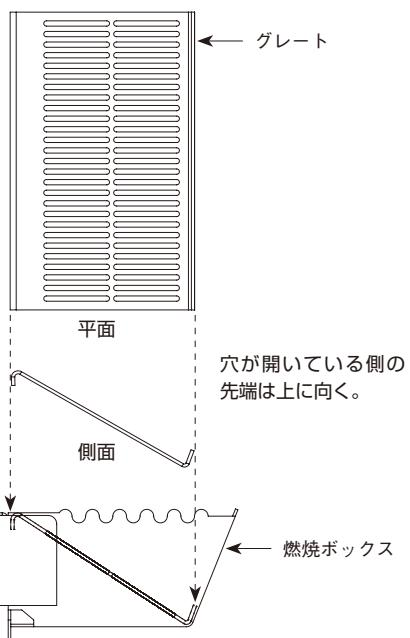
正しい燃焼ボックスの完成図
