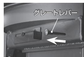
**方法2** グレートレバーを手前に引いて、グレートが開いた状態にし、灰かき棒などのツールを使って、グレートの隙間から灰を落とします。
