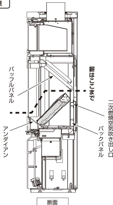
薪を燃焼室上部のバツフルパネルに当たるまで入れないでください。薪の投入量は燃焼室奥のバックパネルの高さまで、なおかつ燃焼室入り口にあるアンダイヤンを超えて落ちない高さにしてください。
