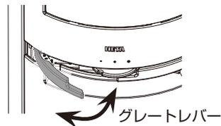
**方法1** グレートレバーを前後に動かして、燃焼室の灰を灰受けボックスに落とします。
