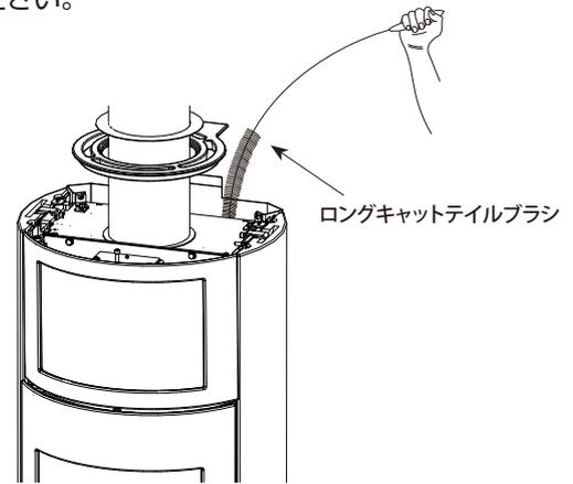
背面、側面の掃除をした後、灰受けドアを開け、内部に落ちたほこりを掃除機で吸い取ります。
