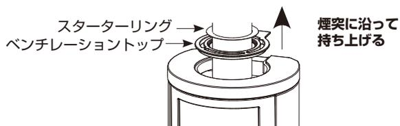
**4** ストーブトップをゆっくりと持ち上げ、ストーブの手前に引いて取り外します。取り外したストーブトップは毛布等で養生した床に置いてください。次にスターターリング、ベンチレーショントップを煙突に沿ってゆっくりとおろしてください。
