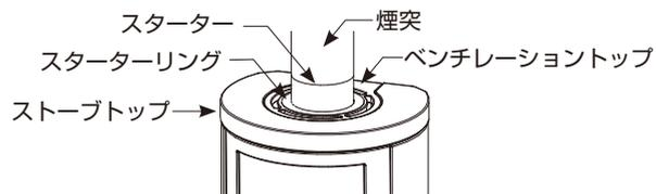
**2** P45『煙突の点検と掃除』の図を参考に、煙突を外してください。
