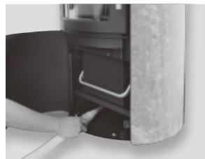
掃除終了後、外した際と逆の手順でソープストーントップ、スターターリング、煙突（ビス止め含む）を取り付けます。
