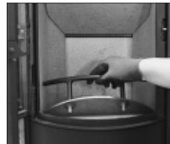
**3** 上部にあるバッフルレパネルの右端部を持ち上げ、斜めにしながら取り出します。
