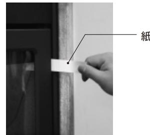
紙を長方形にカットし、ドアと本体の間に挟みこんで燃焼室ドアをロックします。
