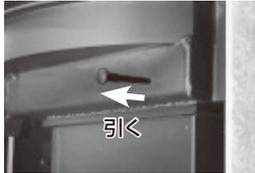
引く<br>↓ グレートレバーを引くとグレートが開く   |
