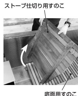
次に、写真のように「底面用すのこ」の端を持ち上げ、ストーブ設置方向に引いて取り外します。
