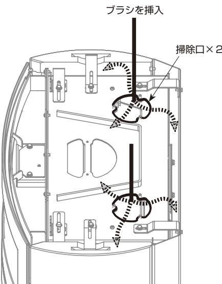
**4** 掃除して落下したススは41ページのパネルの掃除・交換の方法で行ったバッフルパネルを取り外し、掃除機で吸い取るか毛先が柔らかいブラシで掃除を行ってください。
