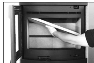
バッフルパネル（①）の上にススが溜まっている場合には、掃除機で吸い取るか毛先が柔らかなブラシで掃除してください。バックパネルプロテクター（②）を外して掃除してください。
