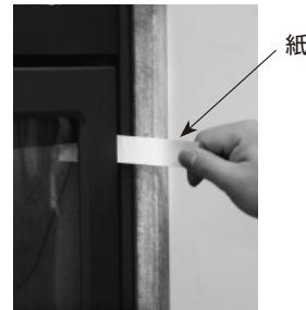
紙を長方形にカットし、ドアと本体の間に挟みこんで燃焼室ドアをロックします。
