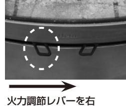
燃焼室の灰は、一定量(2cm以下)あった方が着火しやすく、または薪ストーブの耐久性保持に役立ちます。しかし、グレートの開口部から出る空気を妨げる場合は、下の写真のようにグレートレバーを左右に動かし、グレートの穴が見えるまで灰を落とします。その後、グレートレバーは左に止まるまでスライドさせておきます。※グレートレバーは灰受けドアの中にあります。
