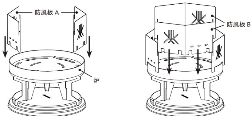
はじめに「防風板A」を八角形の対面同士になるよう「防風板B」が入る間を開けて炉の縁に差し込みます。
