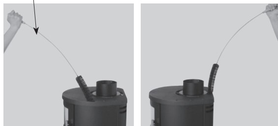
側面对流層の掃除
