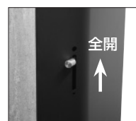
【写真2】 グレートレバーを引くとグレートが開く
