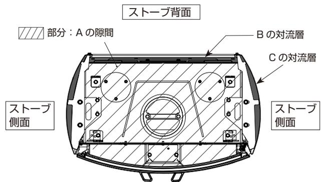
【図1】ストーブトップを外した上面図
