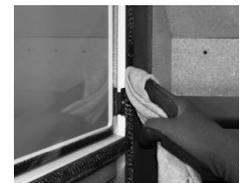
**9** 本体との癒着を防ぐために、必ずドアのロックを解除したまま24時間以上常温で乾燥させてください。
