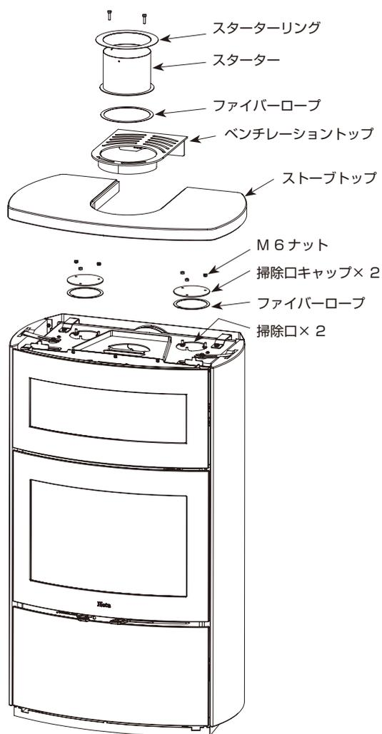
**3** オープン上部の掃除口から、ブラシを差し込み、オープン後面、側面の掃除をします。排気経路は曲がっていて、また狭いため、キャットテイルブラシなどの柄の長いブラシをご用意ください。
