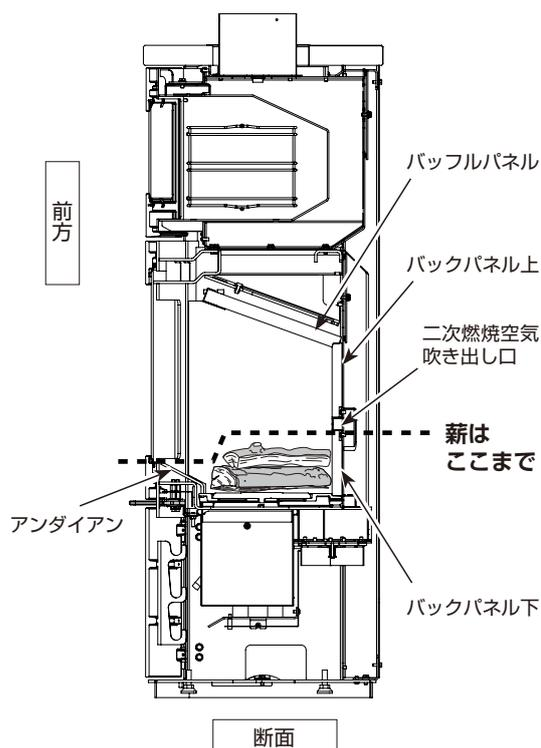
薪の投入量は燃焼室奥にある上下バックパネルの間の二次燃焼空気吹き出し口の下まで、なおかつ燃焼室入り口にあるアンダイヤンを超えて落ち出ない高さにしてください。
