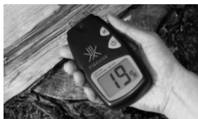
←含水率計 針を薪に差し込むと薪の乾燥度がひと目でわかります。
