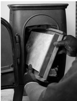
**注意** この時、トップパネル、バックパネルが落下する場合がありますため、気を付けて作業をしてください。
