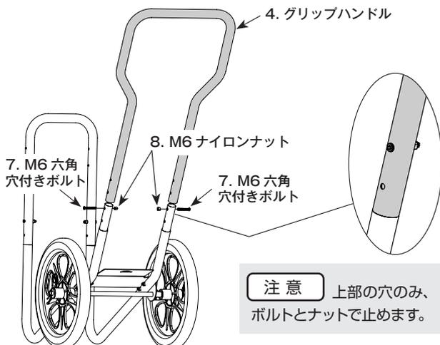
**注意** 上部の穴のみ、ボルトとナットで止めます。
