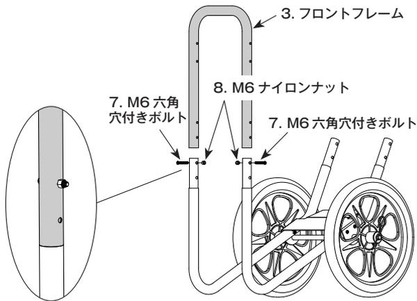
**注意** 上部の穴のみ、ボルトとナットで止めます。
