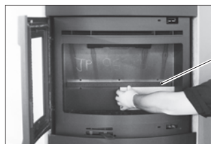
二次燃焼空気 吹き出し口
